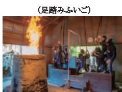
炉に砂鉄と木炭を交互に入れ、「ふいご」で風を送り砂鉄を溶かします。
