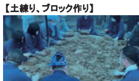
築炉用の粘土を練りブロックを作ります。炉に使用する土は操業の成否を決める重要な役目を果たします。
