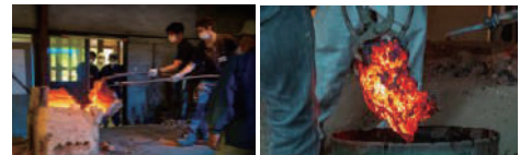
送風管を外し、長い柄のかぎを高熱で溶けた土の炉内縁に掛けて、両側から引き崩し、けらを取り出します。
