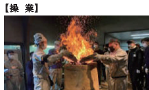
炉に砂鉄と木炭を交互に入れ、「ふいご」で風を送り砂鉄を溶かします。
